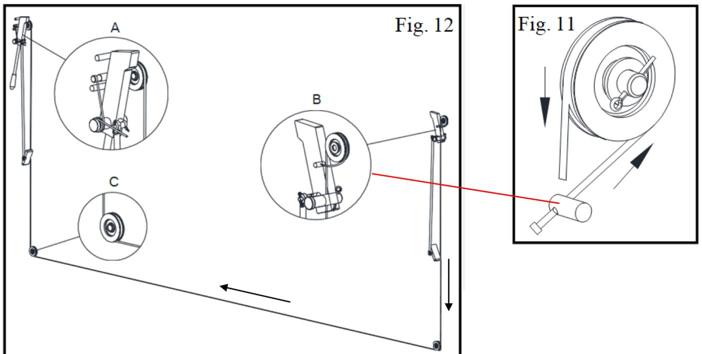
**OBS:** Deve-se montar o cabo de segurança com os carros em uma posição segura, preste atenção na direção da conexão do cabo de segurança.
