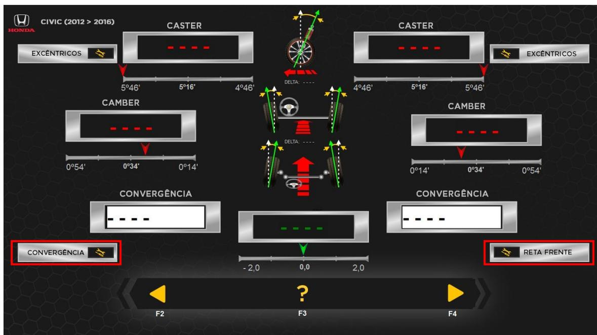
Clicar na opção “RETA FRENTE” e posicionar novamente as rodas, para que o programa calcule a nova reta frente, e clicar em “CONFIRMA”. Verificar se os ângulos ficaram dentro das especificações. Caso não tenha ficado, refazer as correções e repetir este procedimento.
