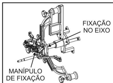
3. Concluída esta parte do processo de aferição, manter a garra no dispositivo de aferição. Colocar um projetor laser no pino da garra e a **escala eletrônica ESQUERDA** a uma distância mínima de **3 metros** da garra que está sendo aferida.
