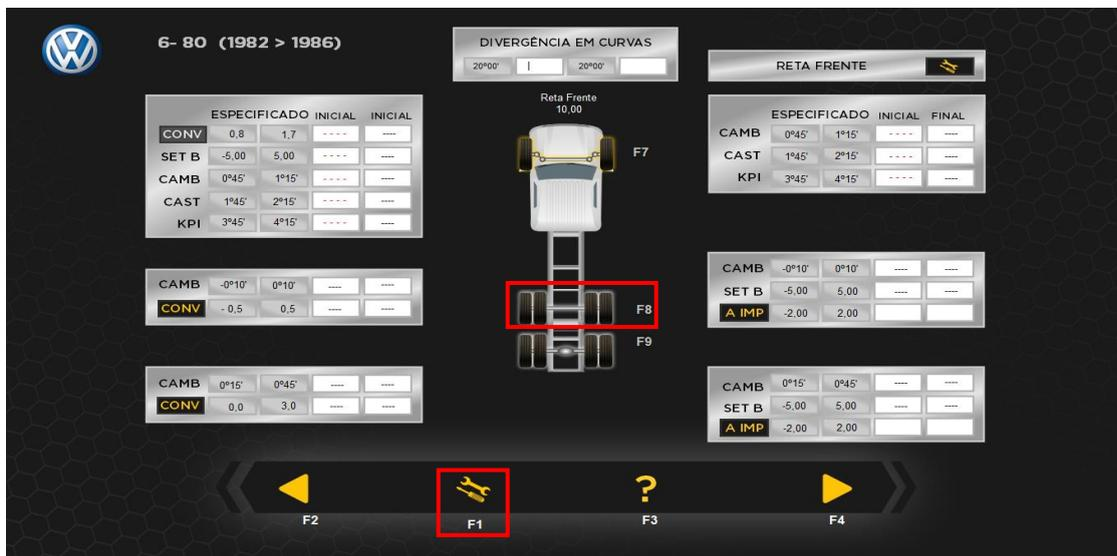
Se necessário, fazer as correções com equipamentos específicos para este fim, deixando os ângulos de Camber, Caster e Convergência dentro da especificação média do fabricante.
