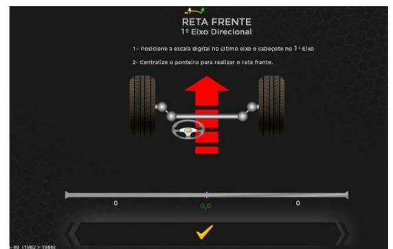
Se necessário, fazer as correções com equipamentos específicos para este fim, deixando os ângulos de Camber, Caster e Convergência dentro da
