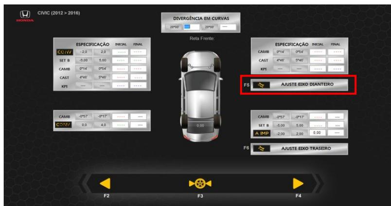
Clicar na opção “AJUSTE EIXO DIANTEIRO”. Todos os valores serão exibidos e poderão ser ajustados. Se necessário, fazer as correções com equipamentos específicos para este fim, deixando os ângulos de Camber e Caster dentro da especificação média do fabricante.
