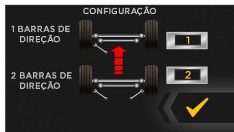
Selecionar o numero de barras de direção do veículo e “CONFIRMAR”. Travar o pedal do freio e o volante.
