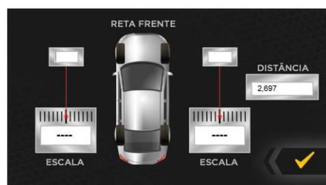
Após o ajuste dos ângulos, pressionar a tecla “CONVERGENCIA” para prosseguir com o ajuste da Convergência.
