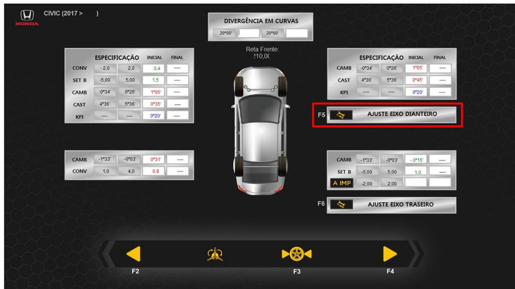
Clicar na opção “AJUSTE EIXO DIANTEIRO”. Todos os valores serão exibidos e poderão ser ajustados. Se necessário, fazer as correções com equipamentos específicos para este fim, deixando os ângulos de Camber e Caster dentro da especificação média do fabricante.
