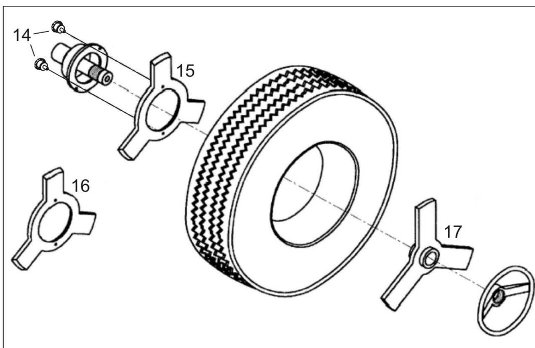
Após isso, deve-se posicionar a roda, posicionar a flange externa (N° 17) e apertá-la com o volante como é demonstrado na figura anterior. É importante citar que a roda deve ser girada com as próprias mãos enquanto é fixada, para garantir que seja centralizada corretamente, sem bater ou ficar torta no eixo da máquina.
