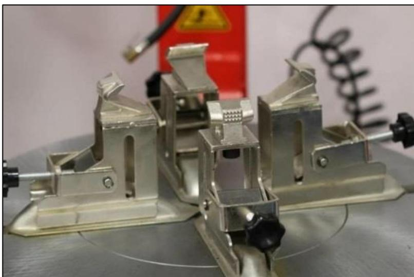
Após isso, basta posicionar o pneu para desmontagem normalmente (figura 3), conforme é descrito no manual da máquina.
