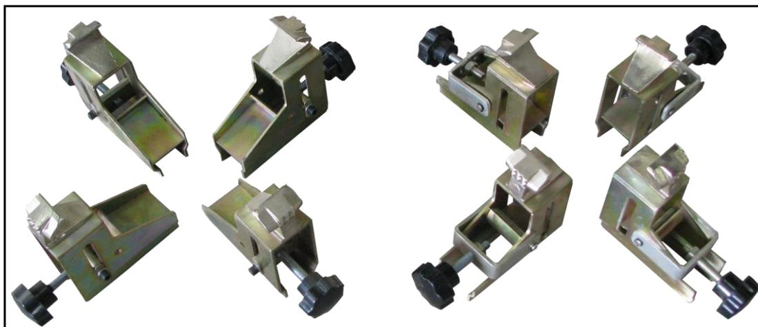
Para instalar o adaptador, basta posicioná-lo sobre os dentes da máquina e apertar o manípulo, que pressionará a peça, fixando-a em sua posição de trabalho.
